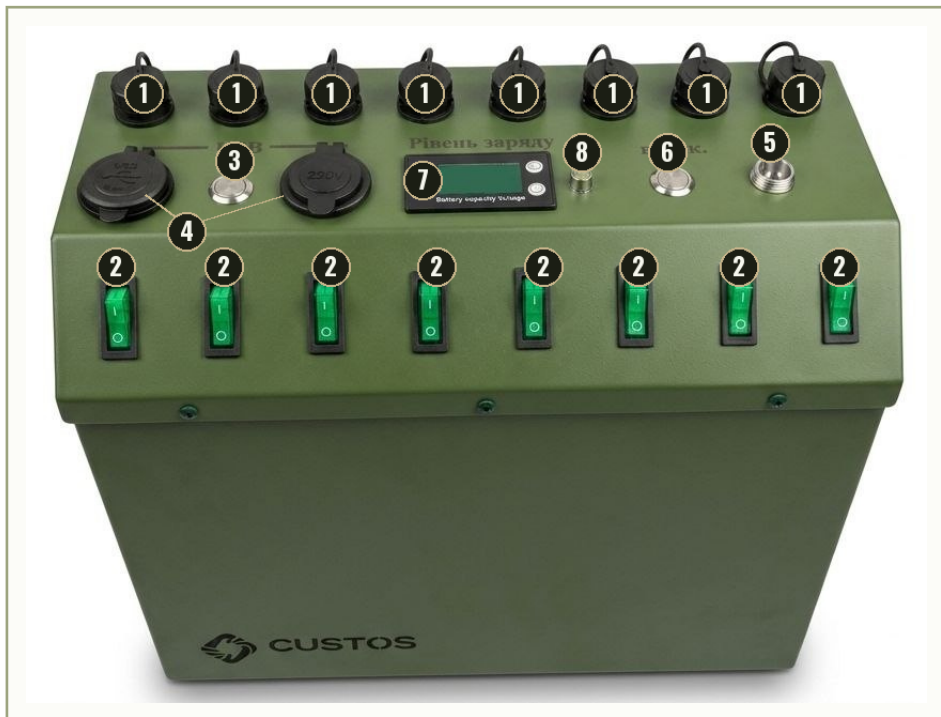
РИСУНОК 10.1 – РОЗТАШУВАННЯ ОРГАНІВ КЕРУВАННЯ ТА ІНДИКАЦІЇ НА ПАНЕЛІ ЗАРЯДНОЇ СТАНЦІЇ
