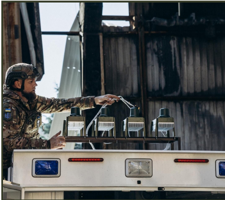
В.3 – ПІДКЛЮЧЕННЯ КАБЕЛІВ ЖИВЛЕННЯ ДО ПОСТАНОВНИКІВ ПЕРЕШКОД
