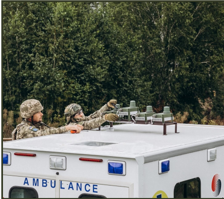
В.1 – МОНТАЖ РАМ З ПОСТАНОВНИКАМИ ПЕРЕШКОД НА ДАХУ ТРАНСПОРТНОГО ЗАСОБУ
