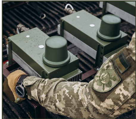
В.4 – ПОСТАНОВНИКИ ПЕРЕШКОД, ЗАКРІПЛЕНІ НА РАМІ ЧЕРЕЗ ІЗОЛЯТОРИ
